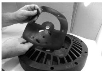
ШАГ 4 Скрепить центральный блок с воздушными камерами
