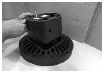
ШАГ 3 Установить фланцы в воздушные камеры
