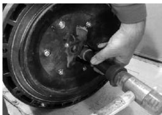
ШАГ 4 Вытолкнуть воздушный клапан наружу таким образом, чтобы он выходил из центрального блока
