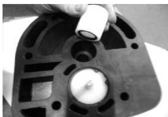
ШАГ 1 Установить подшипники внутри центрального блока
