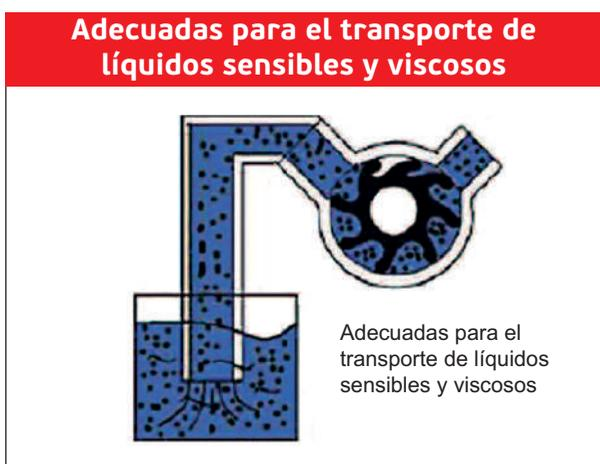
Hasta 75,000 cps, incluso con suspensiones sólidas, sin ningún daño.
