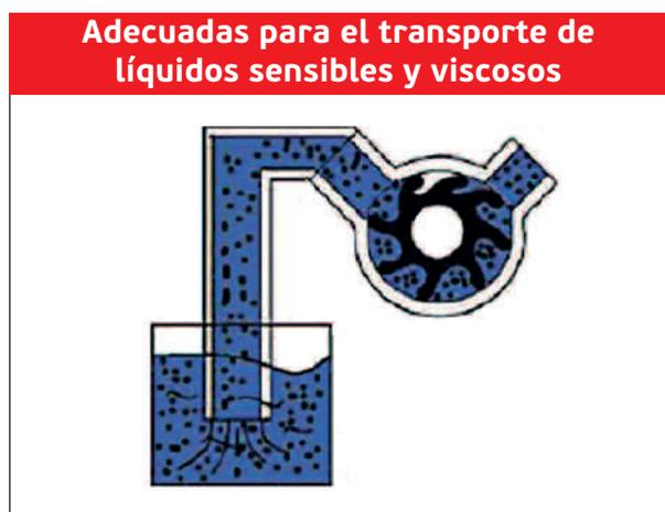
Adecuadas para el transporte de líquidos sensibles y viscosos Hasta 75,000 cps, incluso con suspensiones sólidas, sin ningún daño.
