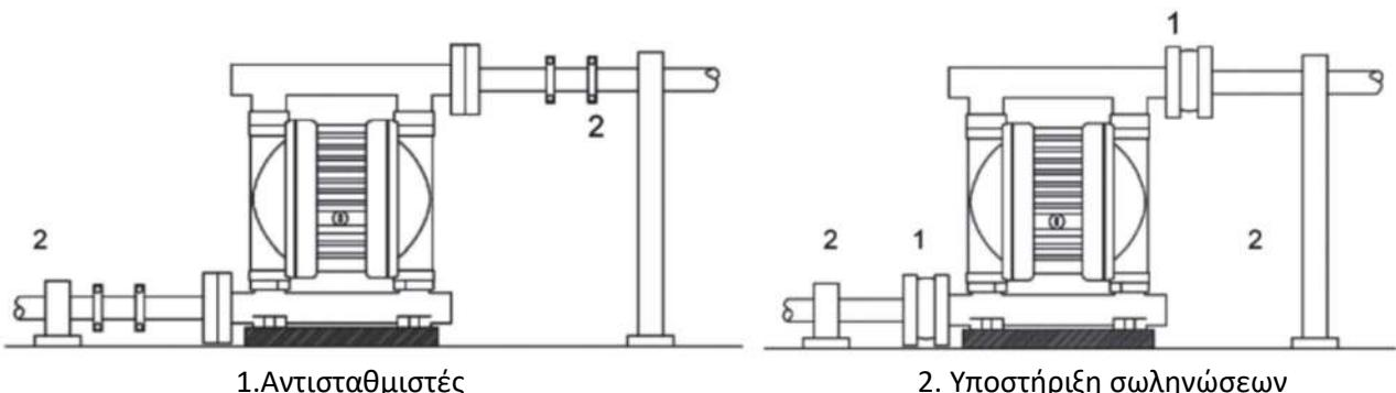
Σχήμα 3. Πρόταση εγκατάστασης Διαφραγματικής αντλίας
