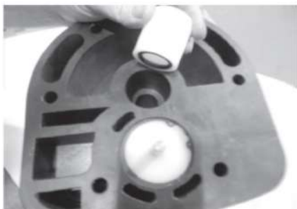
Шаг 1 Установить подшипники внутри центрального блока
