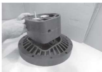
Шаг 4 Скрепить центральный блок с воздушными камерами
