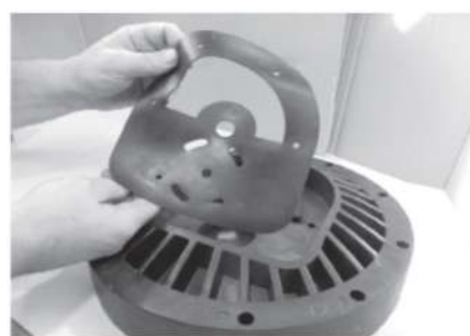
Шаг 3 Установить фланцы в воздушные камеры
