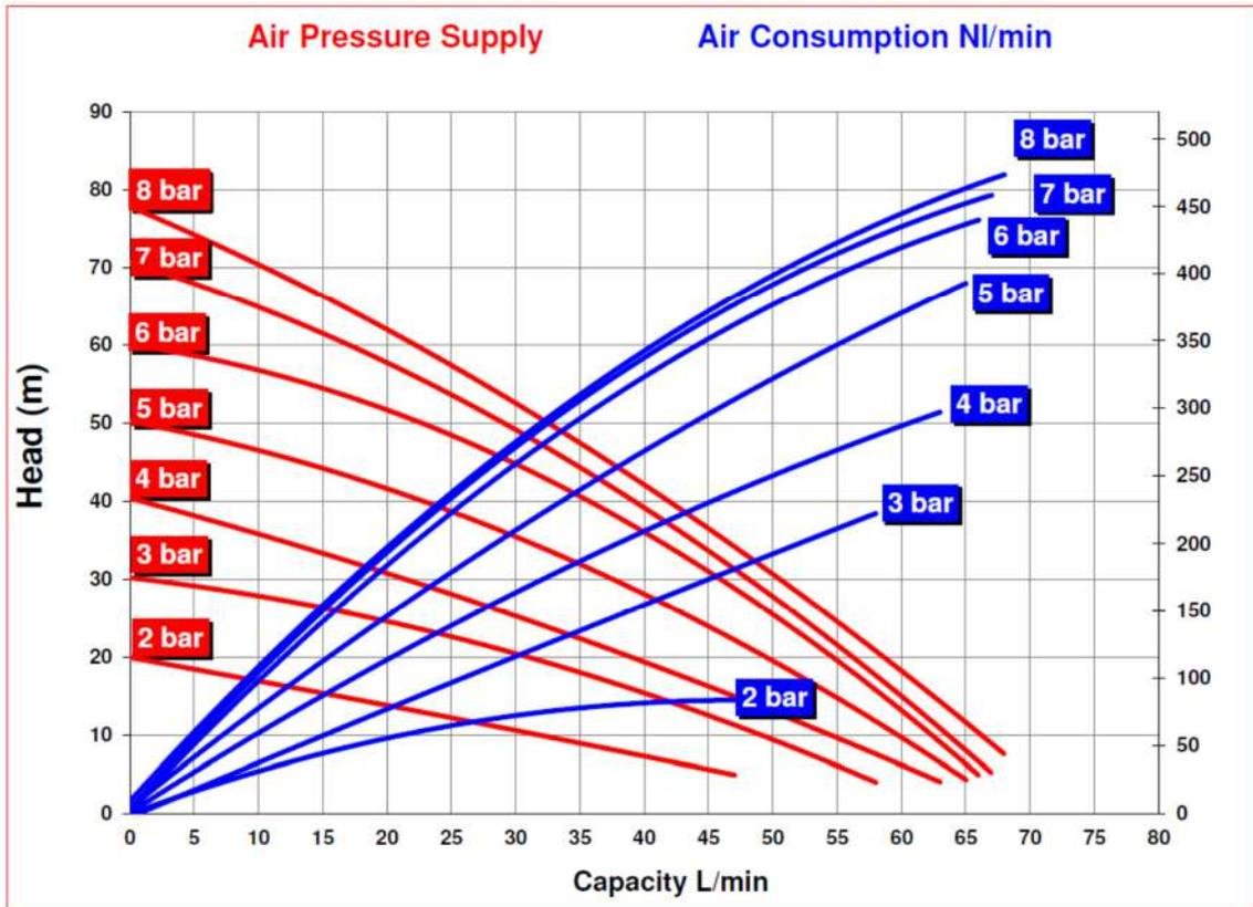
Las curvas y los valores de rendimiento se refieren a bombas con aspiracion sumergida y una salida de suministro libre con agua a 20 °C, y varían según el material de fabricación.
