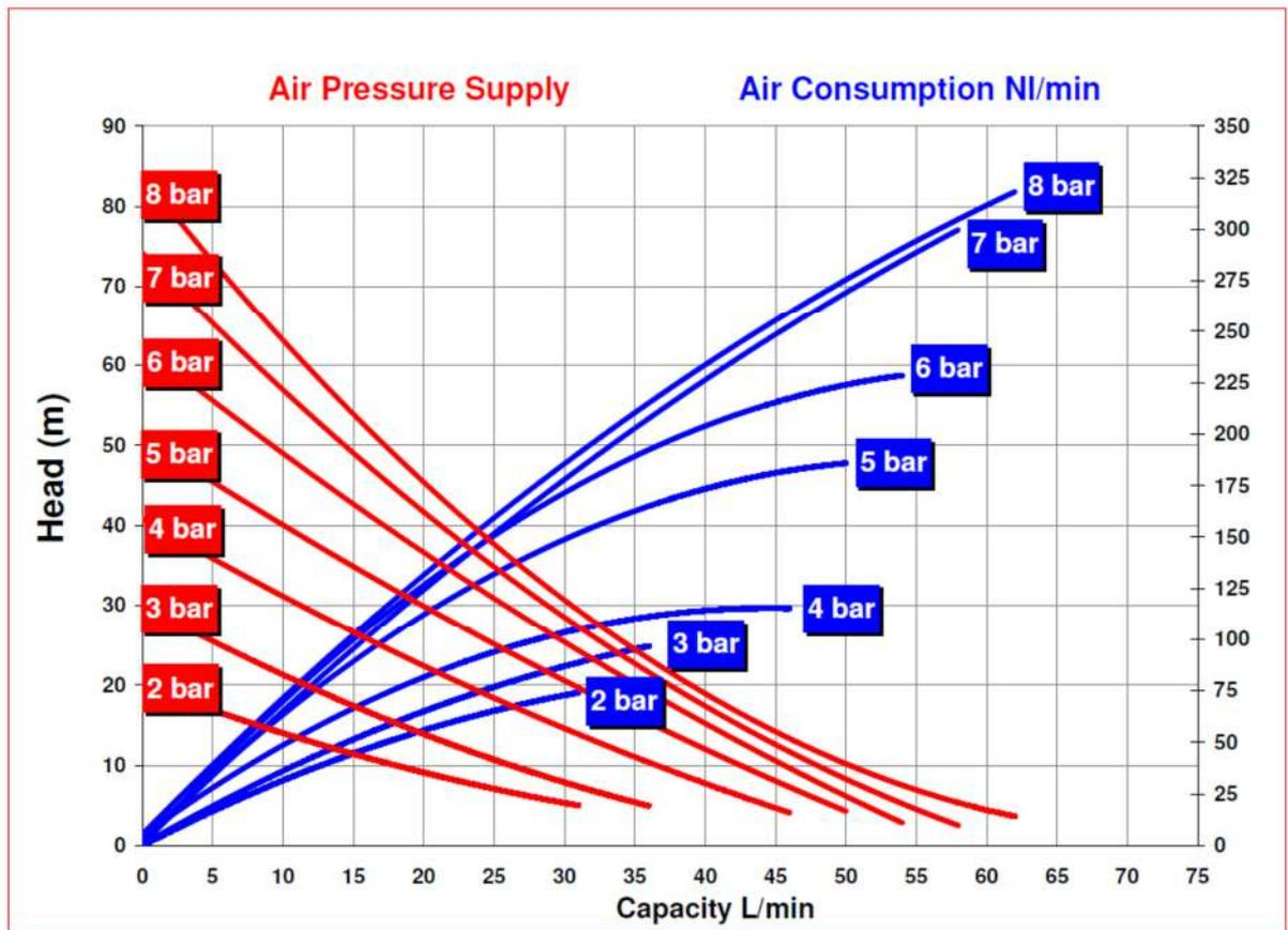
Las curvas y los valores de rendimiento se refieren a bombas con aspiracion sumergida y una salida de suministro libre con agua a 20 °C, y varían según el material de fabricación.
