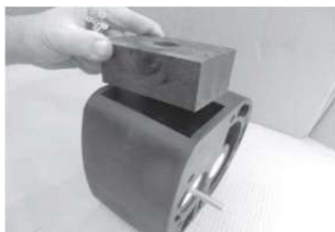
Peso 2 Instale y atomille la cubierta de escape del aire sobre el bloque central.
