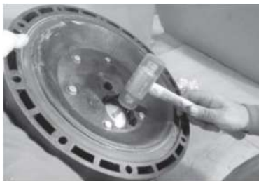
Paso 2 Por un lado, empujamos el eje de la válvula de aire.
