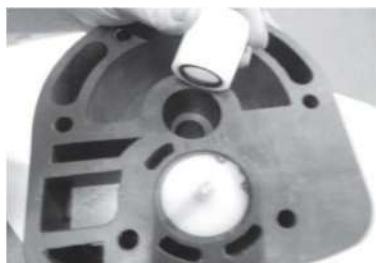
Peso 1 Instale los rodamientos dentro del bloque central de recepción.
