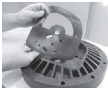
Peso 4 Monte el bloque central con las camaras de aire.
