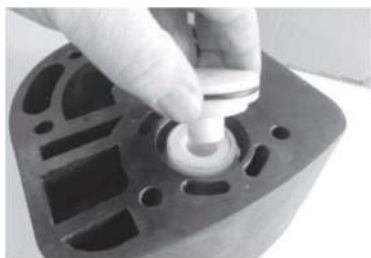
Paso 3b Del lado opuesto retiramos ambos la tapa y el eje de la válvula de aire.
