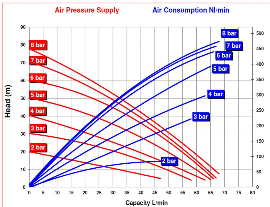
Вышеприведенные данные получены на основании тестов, проведенных при установке насоса ниже уровня воды, при температуре 20°C и могут отличаться в зависимости от материала исполнения насоса.
