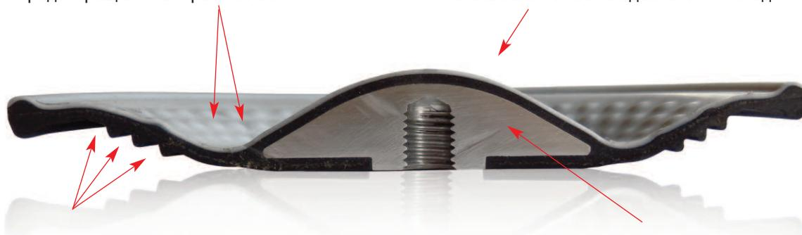
Вспомогательные рёбра обеспечивают и регулируют гибкость диафрагмы для увеличения срока службы и снижения кавитации на входе.
