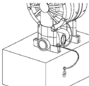
**⚠ ATENCION:** Para líquidos inflamables está prohibido el uso de bombas hechas con material no conductor, que se carguen con electricidad estática y sin una adecuada conexión a tierra:
