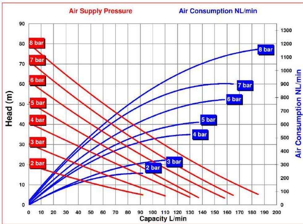
\* Οι τιμές που δίνονται για τις καμπύλες και τις αποδόσεις αφορούν αντλίες με εμβαπτιζόμενη αναρρόφηση και ελεύθερη κατάθλιψη, για νερό στους 20 °C και ποικίλουν ανάλογα με το υλικό της κατασκευής
