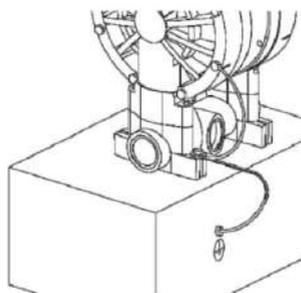
**⚠ ΠΡΟΕΙΔΟΠΟΙΗΣΗ:** Δεν επιτρέπεται η χρήση των αντλιών για εύφλεκτα υλικά και χωρίς κατάλληλη γείωση , όταν αυτές είναι κατασκευασμένες με μη αγώγιμα υλικά.
