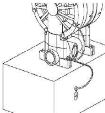
**⚠ ПРЕДУПРЕЖДЕНИЕ:** использование насосов, изготовленных из непроводящих материалов, которые могут заряжаться статической энергией, и без подходящего заземления для легковоспламеняющихся жидкостей запрещается:
