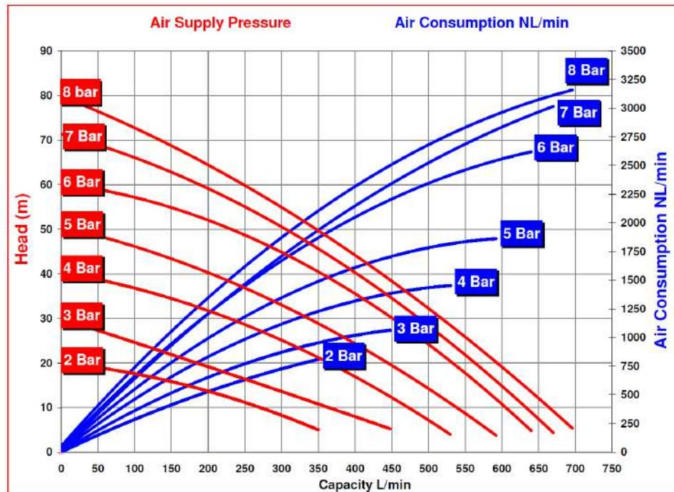
Вышеприведенные данные получены на основании тестов, проведенных при установке насоса ниже Уровня воды, при температуре 20°C и могут отличаться в зависимости от материала исполнения насоса.
